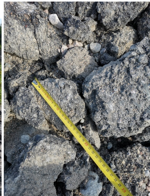
Kuva 7 ja 8. Aiemmin kentän pinnalla olleet isot asfalttipalat on jätetty sorakerroksen alle, sorapintaisen kentän reunasta näkyy vielä asfalttia. Mittakuva silmämääräisesti arvioituna keskikokoisesta kappaleesta.
