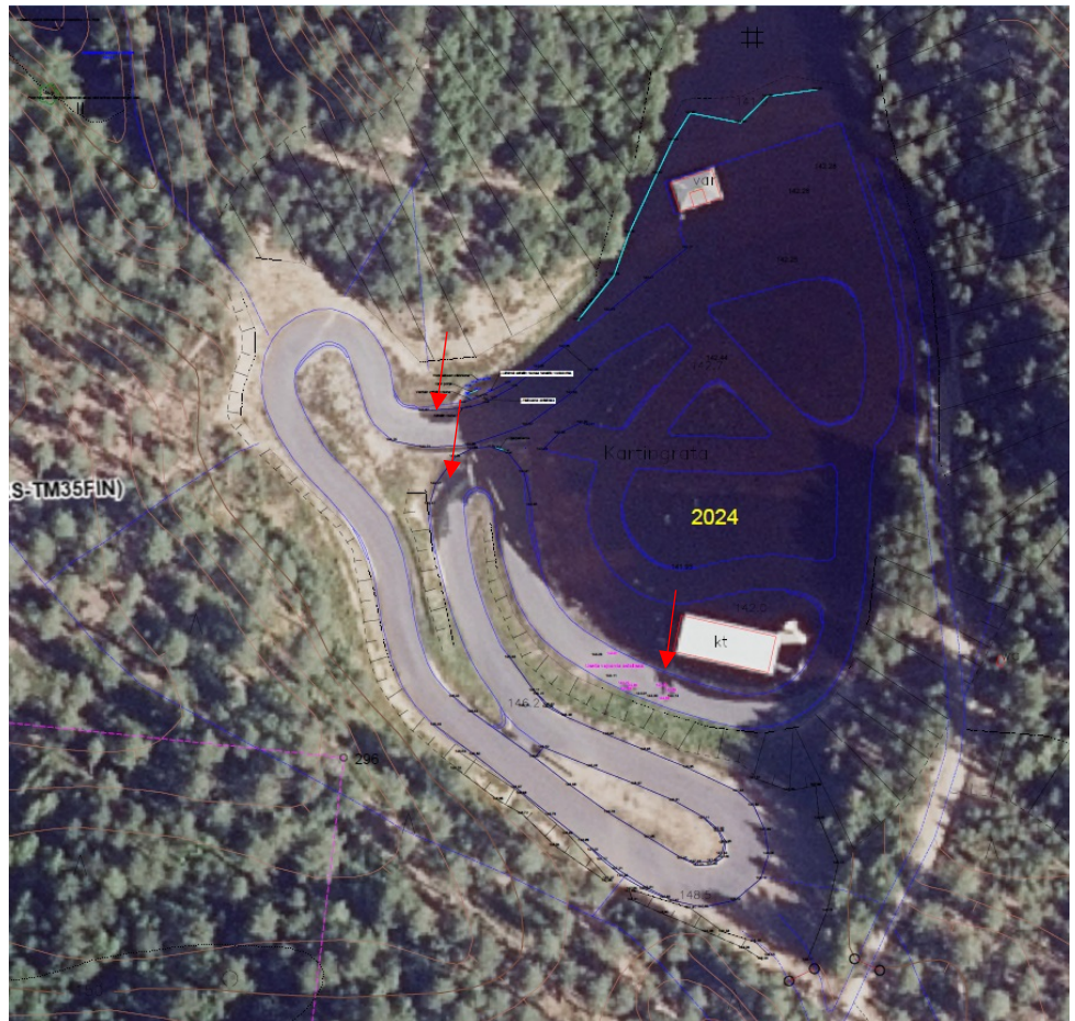
Kuva 1. Ilmakuva vuodelta 2024. Punaisilla nuolilla on merkitty kolme purkautumiskohtaa kuvaan. Ilmakuvat on sijoitettu mittauksen alle silmämääräisesti alueella olevien rakennuksien sijaintia hyödyntäen.
